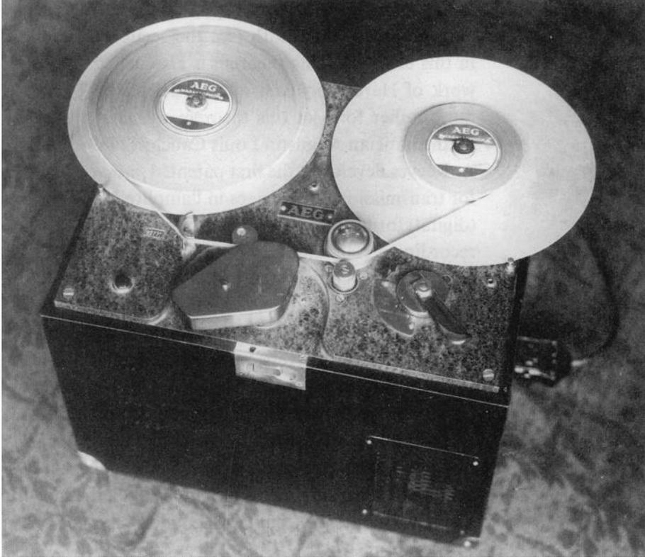
Figure 1.3 – Prototype d'un enregistreur à bande portable Magnetophon de 1935, construit par AEG (avec l'aimable autorisation de BASF Aktiengesellschaft).
