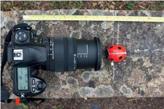
◀ Reflex muni d'un objectif Sigma 17-70 mm : la flèche rouge indique le plan focal.
