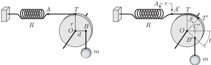
Notons  $r$  le rayon de la roue et  $d$  la distance  $OB$ . À l'équilibre, le point d'attache du poids est en  $B'$  et le vecteur  $\overrightarrow{OB'}$  fait l'angle  $\theta$  avec l'horizontale.
