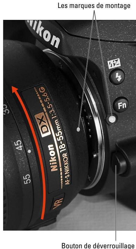
**Figure 1.1 :** Alignez les marques de montage de l'appareil et de l'objectif.
