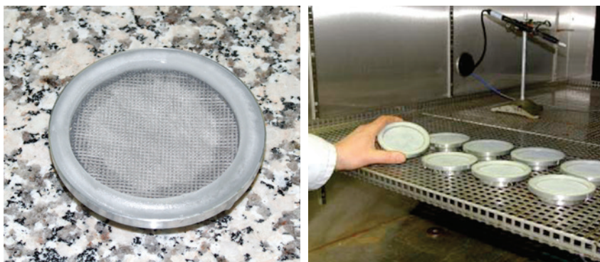
Figure 4 : Mesure de la perméance d'un écran de sous-toiture
