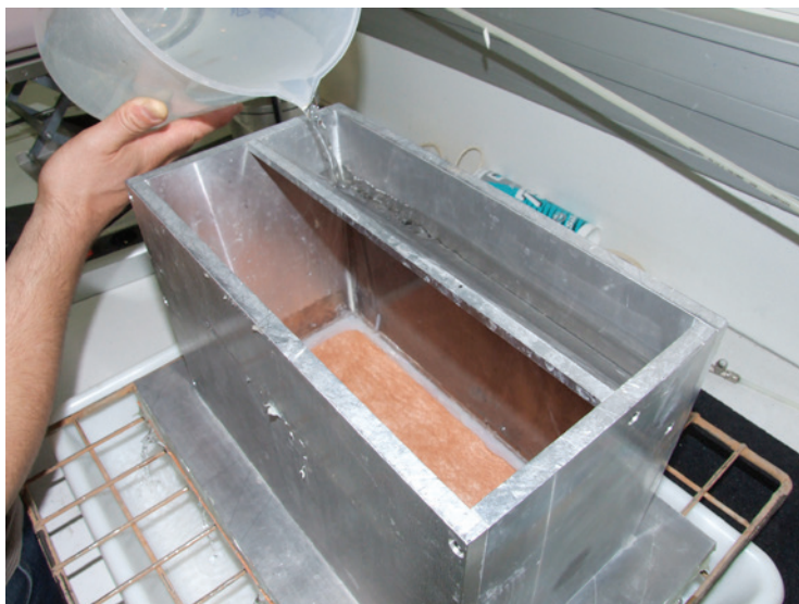
Figure 2 : Essai de résistance à la pénétration d'eau (classe W_2 )
