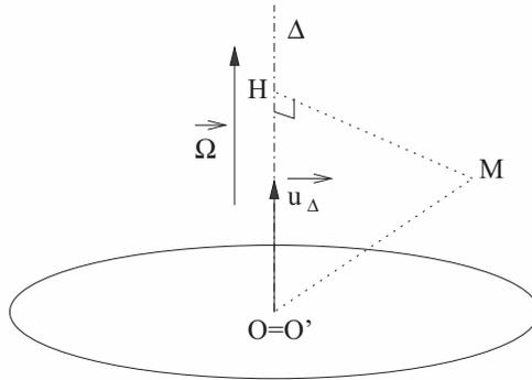
$$\begin{cases} \vec{v}_a = \vec{v}_{\mathcal{R}_0}(P) + \vec{v}_r \\ \vec{a}_a = \vec{a}_{\mathcal{R}_0}(P) + \vec{a}_C + \vec{a}_r \end{cases} \text{ soit } \begin{cases} \vec{v}_{\mathcal{R}_0}(M) = \vec{\Omega} \wedge \vec{O'M} + \vec{v}_{\mathcal{R}}(M) \\ \vec{a}_{\mathcal{R}_0}(M) = -\Omega^2 \vec{HM} + 2\vec{\Omega} \wedge \vec{HM} + \vec{a}_{\mathcal{R}}(M) \end{cases}$$
