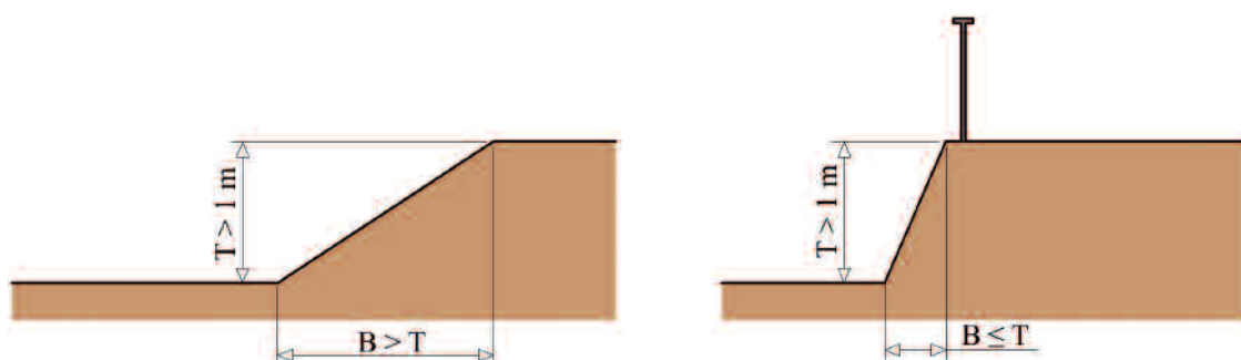
Pas d'obligation de mettre un garde-corps
