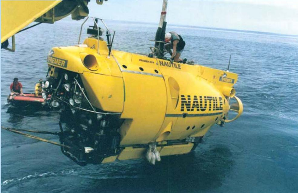
L'étude de l'hydrosphère et des fonds marins suppose le développement de nombreux outils adaptés. Le sous-marin Nautilus emmène un scientifique et deux pilotes jusqu'à 6 000 m de fond. Il est capable de prélever des échantillons et d'effectuer de nombreux travaux autour de sites particuliers comme les sites hydrothermaux. Aujourd'hui, il tend à être supplanté par les ROV dont les temps de plongée sont nettement supérieurs (voir fiche 156)
