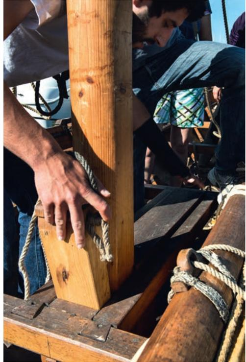
Armement du bateau. Mise en place du mât et haubanage
