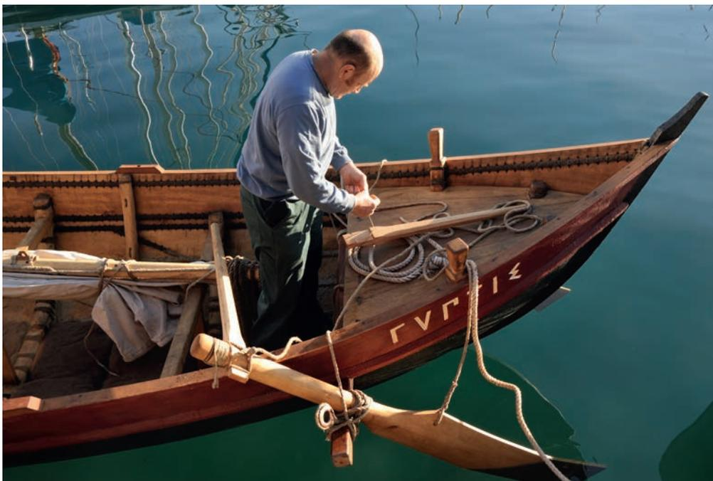
Préparatifs de départ et mise en place des gouvernails latéraux. Les gouvernails reposent sur un bau traversant débordant de chaque côté de la coque.
