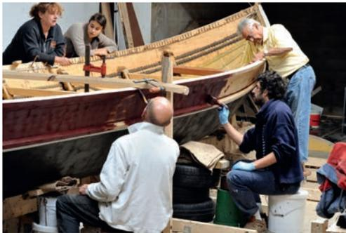
Essais des enduits d'étanchéité (cire d'abeille et poix de conifère) et application à l'intérieur et à l'extérieur de la coque. L'enduit est coloré avec du noir de charbon pour la carène et avec des oxydes de fer pour le rouge lie-de-vin du pavois. Ce sont les couleurs des bateaux antiques attestées par les textes et l'iconographie.
