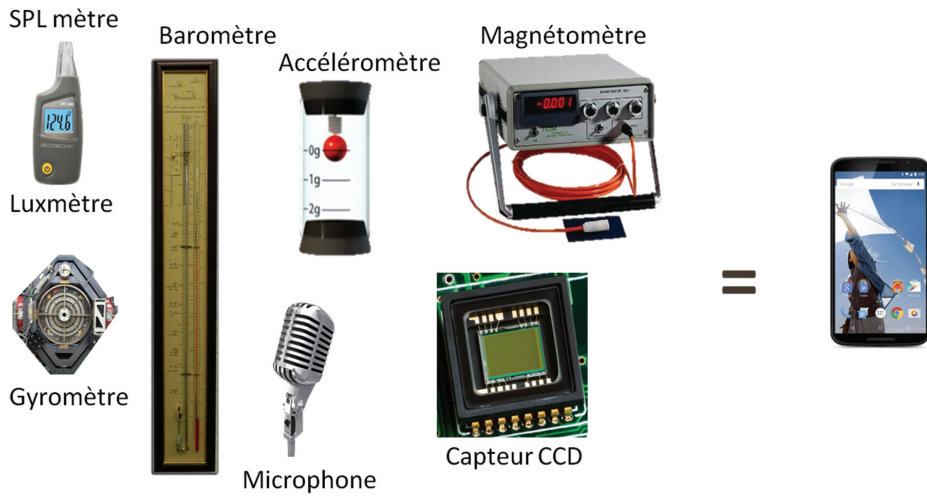
Figure 1.3 – Un smartphone est un mini-laboratoire mobile. Exemples de capteurs intégrés dans un smartphone.
