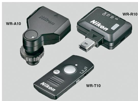
◀ Ensemble de télécommande sans fil. La touche Fn de la télécommande est programmable via le menu **f16** de l'appareil.
