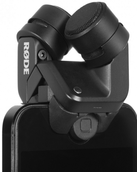
Figure 1.2 – Le microphone RØDE i-XY est un couple de capsules statiques appairées de haute qualité. Il est compatible avec tout appareil muni d'un port Lightning.
