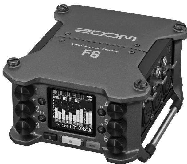
Figure 1.6 – Le Zoom F6 est un enregistreur multipiste de terrain très compact, 6 entrées/6+2 pistes, d'une qualité audio supérieure (enregistrement en 32 bits virgule flottante !).
