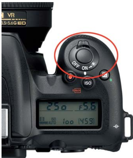
Figure 1.4 Le sélecteur d'allumage du boîtier, poussé au maximum, éclaire l'écran de contrôle supérieur.
